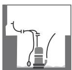
التوضيح لتركيب عدد الوزن اختر حلقة من البلاستيك من الحقيقة البولييثين ووضع حلقة حول كابل ، ثم أدخل الكابل في الوزن مضادة في الجانب جزء مخروطي الشكل وأصلاحها مع ضغط معتدل في تحديد نهاية . برجي الرجوع الشكل .
